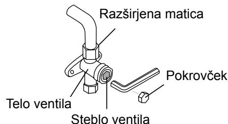
12. S šestrobnim ključem do konca odprite visokotlačni in nizkotlačni ventil.
